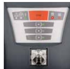
Czerwone diody: informacja o zapchanym filtrze głównym
